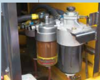
▲强化燃油滤清系统, 采用3连燃油滤清器 通过将3连滤清器配置在同一位置, 提高更换时的效率, 免去攀爬的麻烦, 提高安全性
