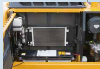
▲冷却器, 油冷器与中冷器并排配置, 让冷却效果更佳
